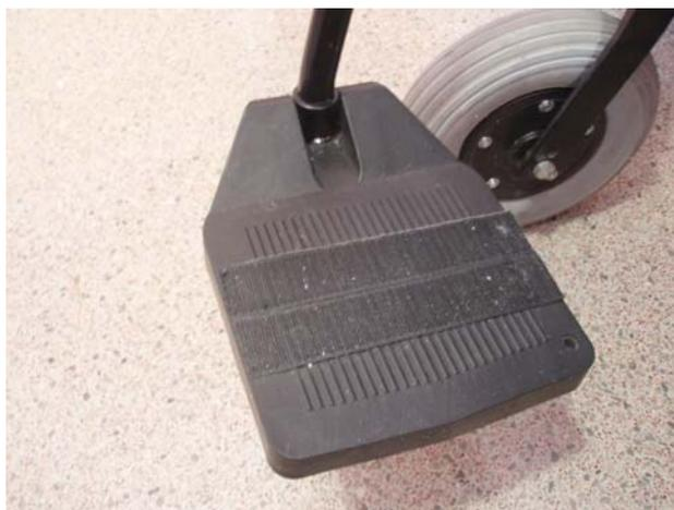
Vista del reposapiés de la silla de ruedas con el Velcro fijado.
